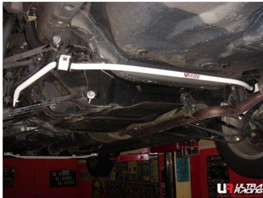
Obrázek 4: Zadní stabilizátor Honda Accord[8]
