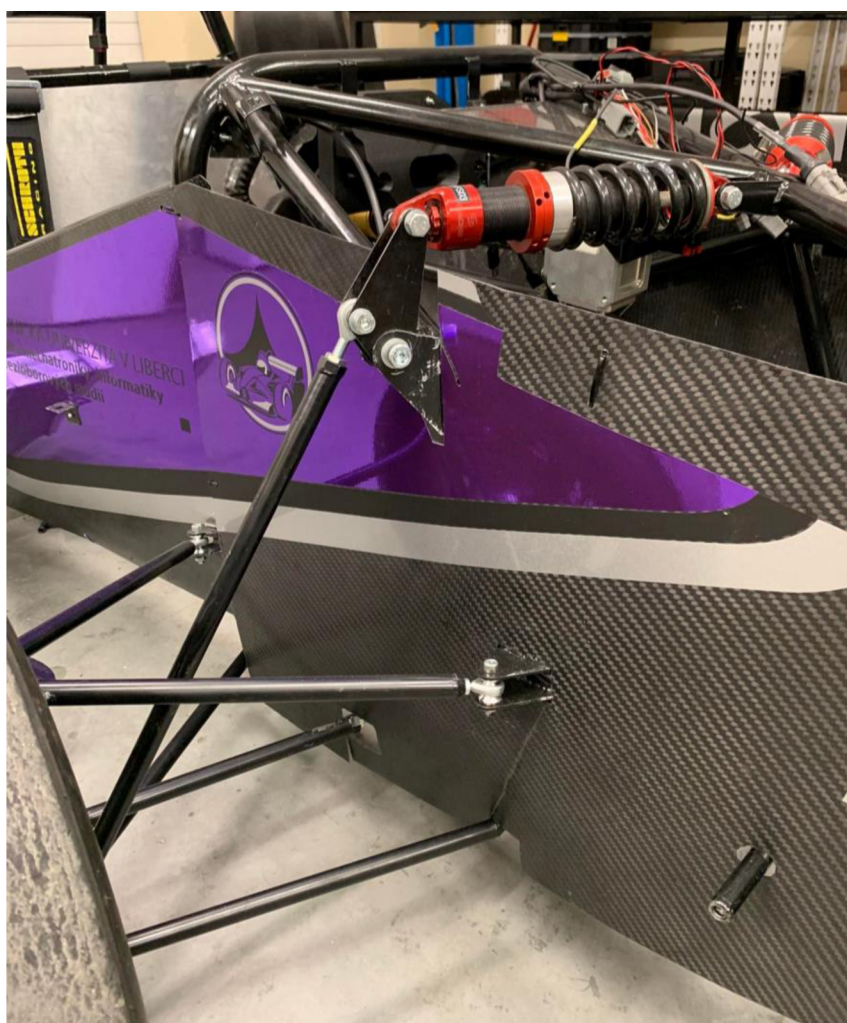
Obrázek 29 Konstrukce předního pushrodu s vahadlem a tlumičem
