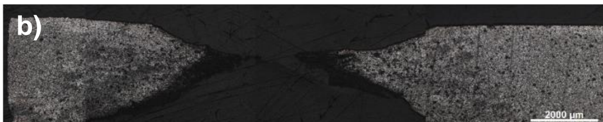
Obrázek 9: Porovnání chování materiálu při přetavování při 8 mA; a) zjemněná povrchová vrstva litého Mg, b) Mg lisovaný při 500 MPa za studena
