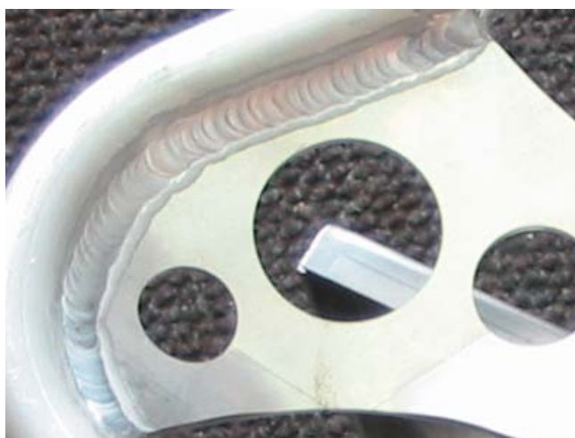
Obr. 2.6 Ukázka svaru na hliníku [11]
