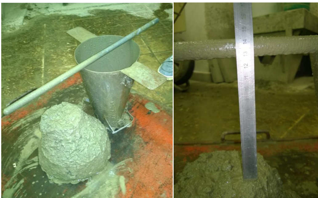
Obrázok 17: Sadnutie kužela, stupeň S3 - 130 mm
