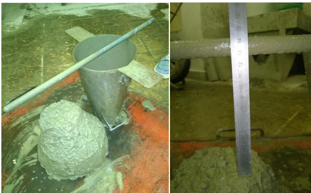
Obrázok 17: Sadnutie kužela, stupeň S3 - 130 mm
