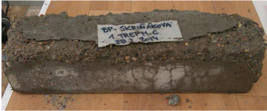
Obrázok 18: Tráмец s NA po zmrazovacích cykloch
