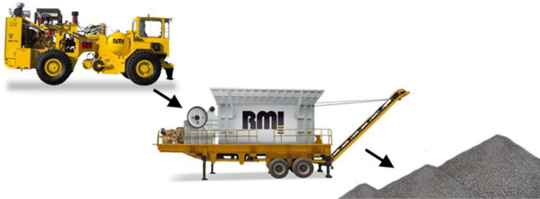
Obrázok 5: Rezonančná recyklácia betónu [24]
