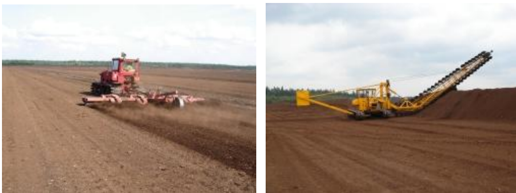
Obr. č. 8 a 9: Těžba rašeliny – frézování a úprava valů, zdroj: http://www.raselina.cz/cinnost-firmy/tezba
