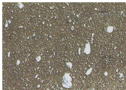
Obr. 48: Mikrostruktura střepe blanské lineární keramiky – ukázka kvalitně vypáleného střepe (teplota výpalu nepřesáhla teplotu 800°C) (převzato z: Kloužková 2002)
