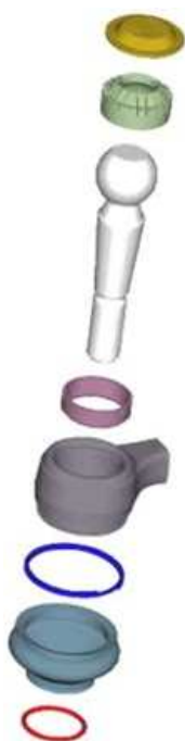
Obr. 11 Kulový kloub řízení, OBJ, přenášející radiální zatížení [2]
