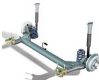
Obr. 6 Kliková náprava s torzním propojovacím prvkem [2]
