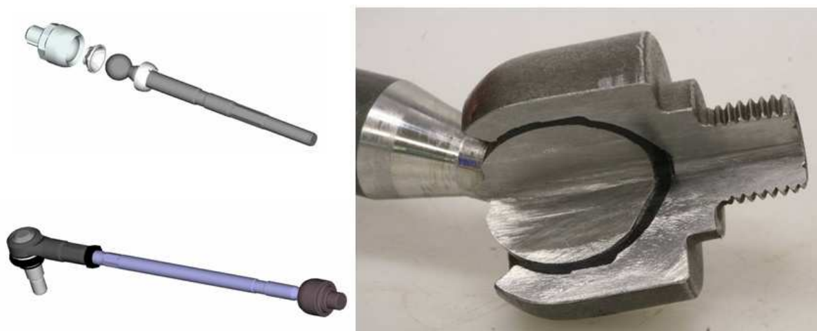
Obr. 12 Kulový kloub řízení vnitřní, IBJ, přenášející axiální zatížení [2]
