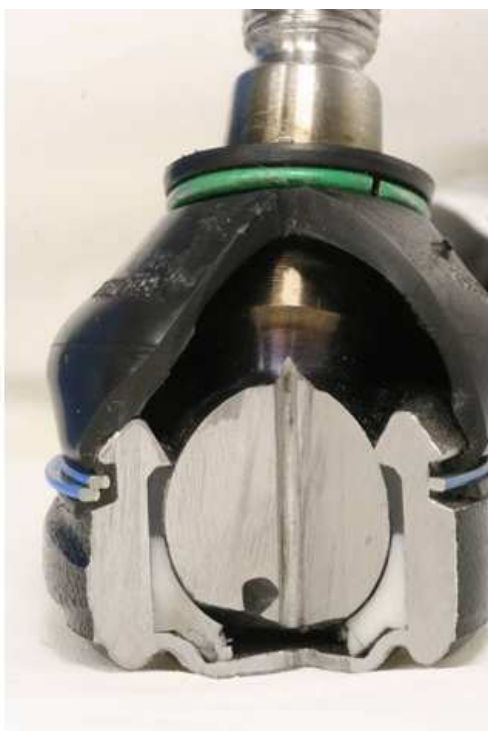
Obr. 11 Kulový kloub řízení, OBJ, přenášející radiální zatížení [2]
