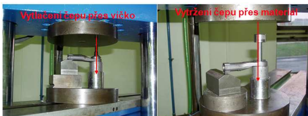
Obr. 18 Vytlačení čepu přes víčko a přes materiál
