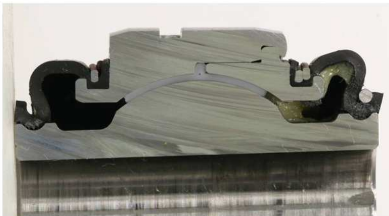
Obr. 10 Dutý kulový kloub, PBJ, přenášející radiální zatížení [2]
