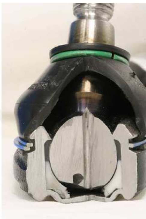
Obr. 11 Kulový kloub řízení, OBJ, přenášející radiální zatížení [2]
