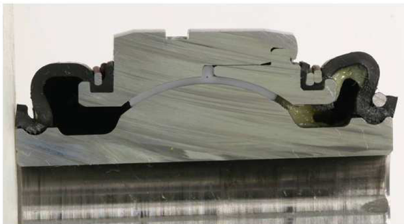
Obr. 10 Dutý kulový kloub, PBJ, přenášející radiální zatížení [2]
