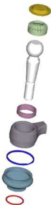
Obr. 11 Kulový kloub řízení, OBJ, přenášející radiální zatížení [2]
