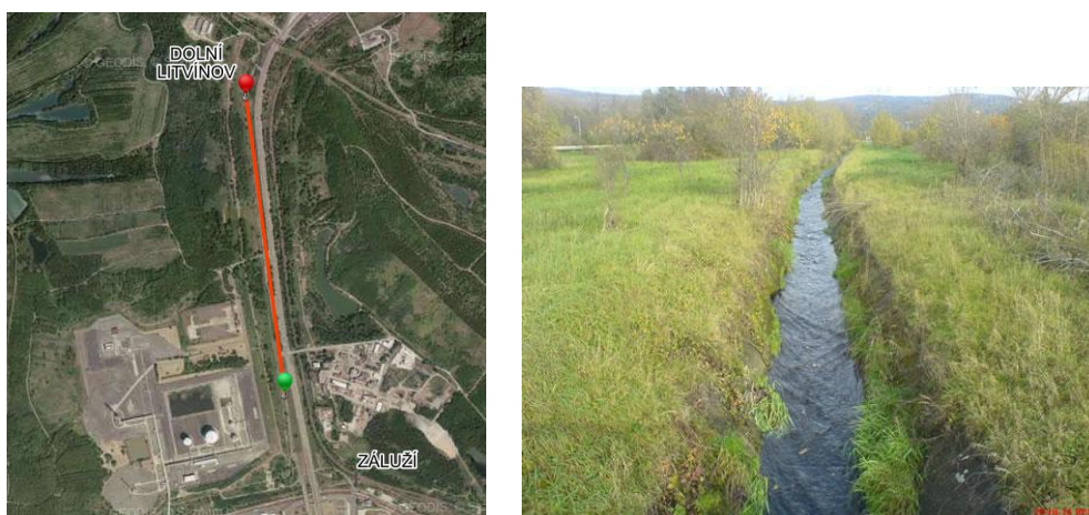
Obr. č. 85, 86 – Na levém obrázku znázornění úseku vhodného k revitalizaci; na pravém obrázku napřímení koryta (foceno proti proudu) úseku BPO008 (mapy.cz + autor 2015).
