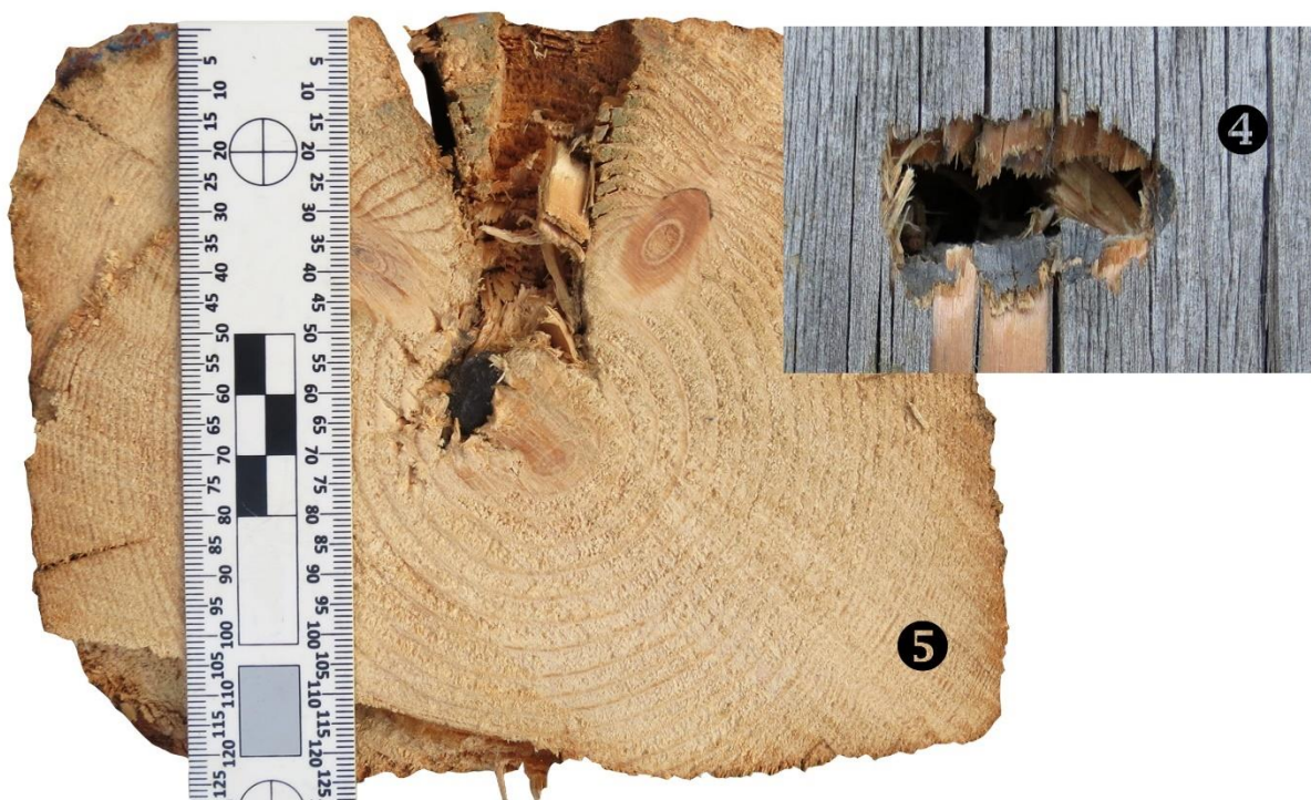
Tabulka č. 33: Výsledky experimentální střelby, střelba na dřevěný stavební prvek.
