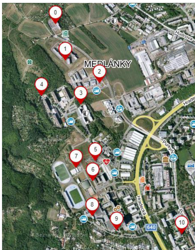
Obrázek 4.1 Rozmístění trafostanic v LDS Pod Palackého vrchem
