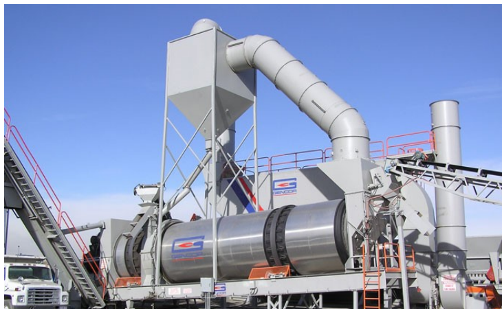
Obr. 5: Kontinuální obalovna GENCOR ULTRAPLANT®[22]
