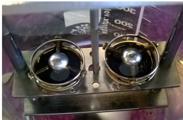
Obr. 14: Prstence pro centrování kuliček během zkoušky
