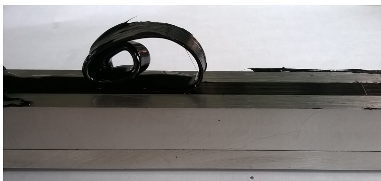
Obr. 22: Seříznutí přebytečného pojiva
