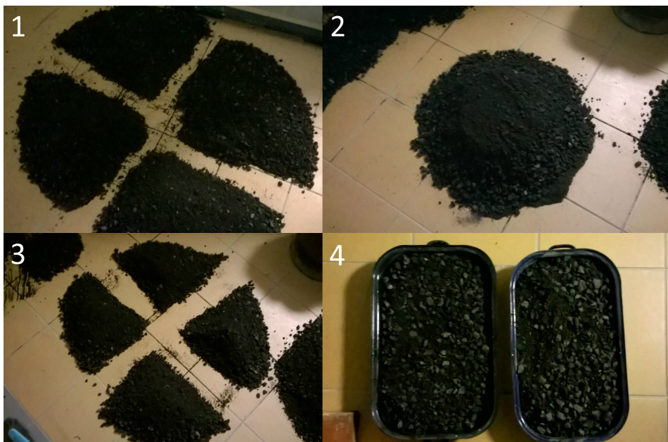
Obr. 6: Postup prováděné kvartace na vzorku R-materiálu
