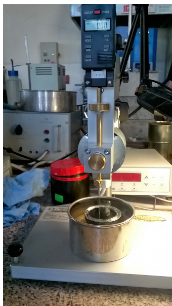
Obr. 12: Provádění zkoušky penetrace penetrometrem
