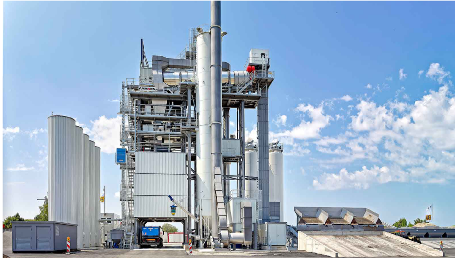
Obr. 4: Šaržová obalovna s paralelním bubnem[21]
