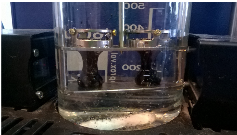
Obr. 15: Protážení pojiva během zkoušky bodu měknutí
