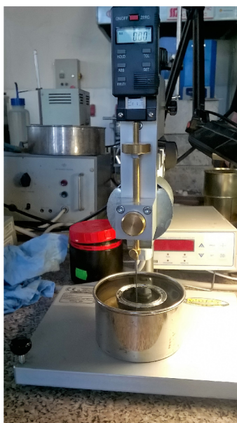
Obr. 12: Provádění zkoušky penetrace penetrometrem
