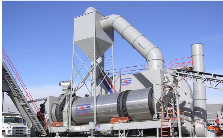
Obr. 5: Kontinuální obalovna GENCOR ULTRAPLANT® [22]
