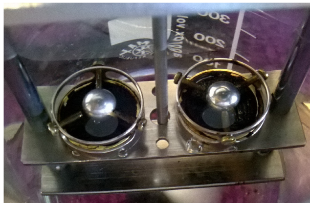
Obr. 14: Prstence pro centrování kuliček během zkoušky
