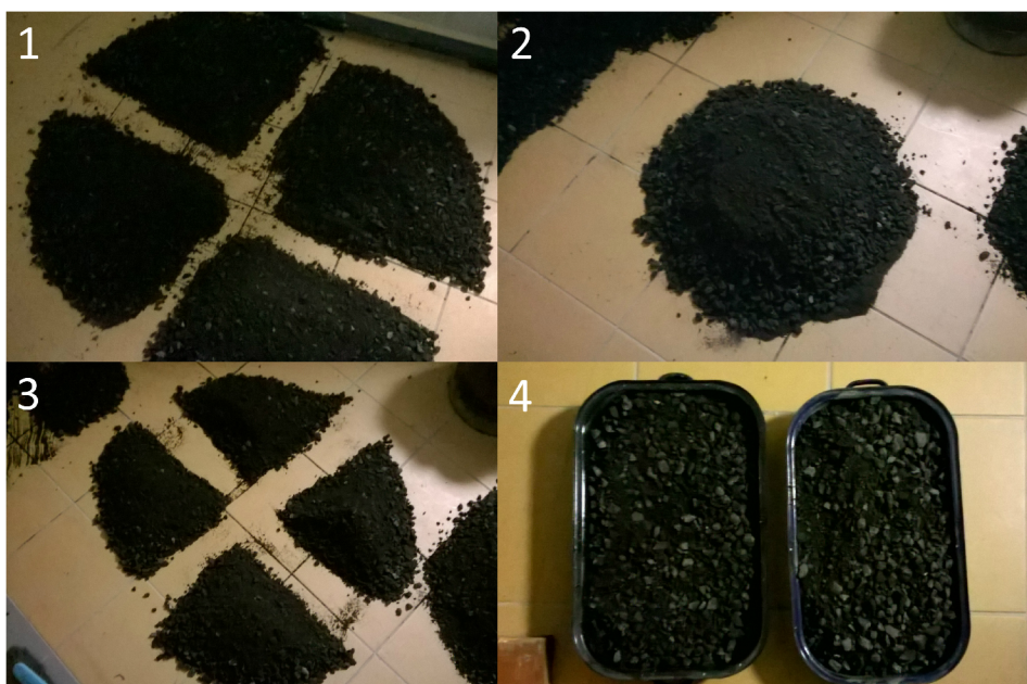
Obr. 6: Postup prováděné kvartace na vzorku R-materiálu
