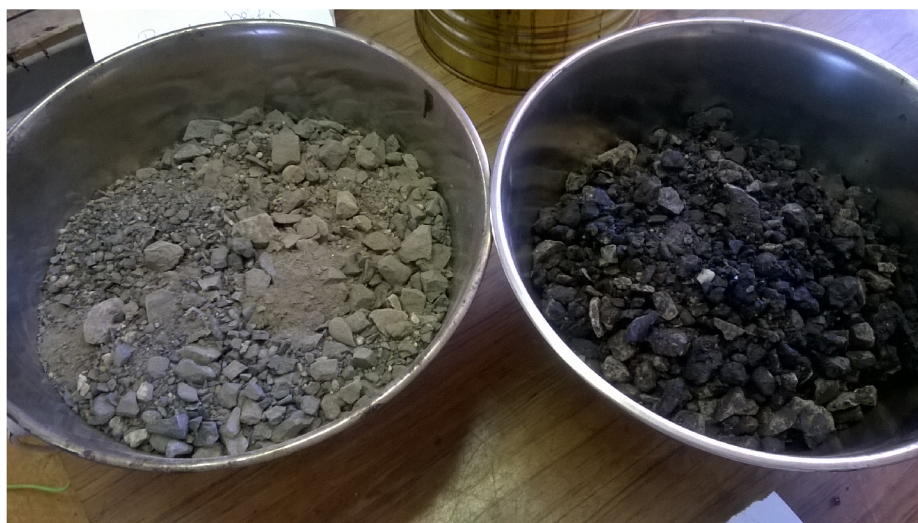
Obr. 9: Vysušené kamenivo získané z R-materiálu (vlevo) a původní R-materiál (vpravo)
