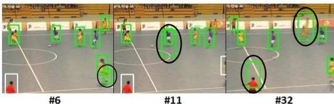
Obrázek 6.10: Ukázka falešných či nepřesných detekcí. Na snímku 6 a 11 lze vidět příklad falešné detekce, která je při testování započítána. Snímek 32 ukazuje nepřesnost detektoru, kdy je detekované okno znatelně větší než by mělo být.
