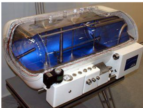
Obr. 14 Průřez nádrže na kapalný vodík [54]
