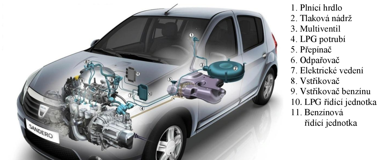
Obr. 8 Schéma základních komponentů v automobilu Dacia Sandero [64]
