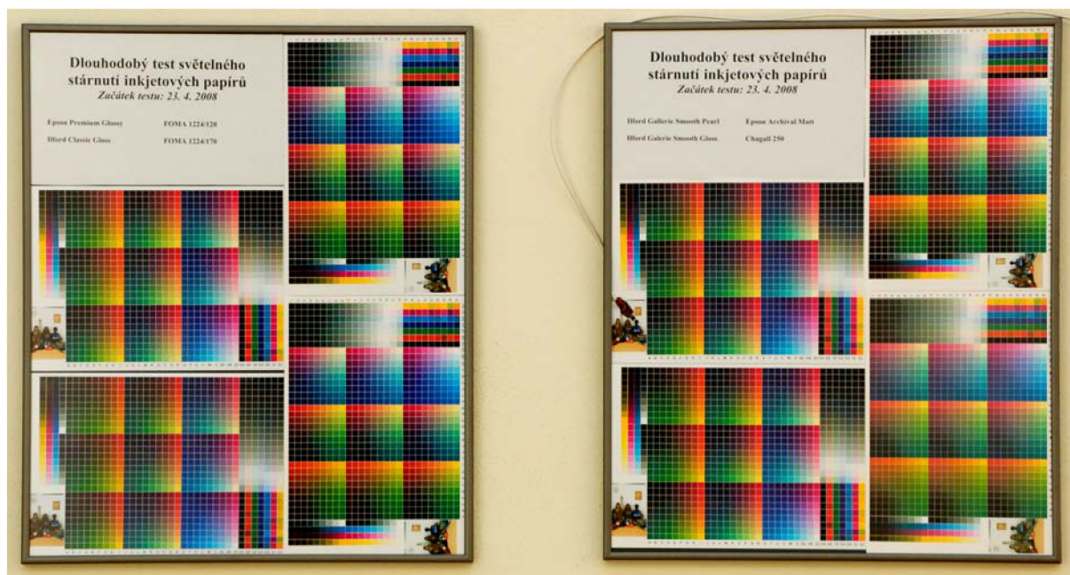
Obr. 16 Testovacie targety v rámoch umiestnených na stene slnečnej chodby spolu so senzorom intenzity ožiarenia.
