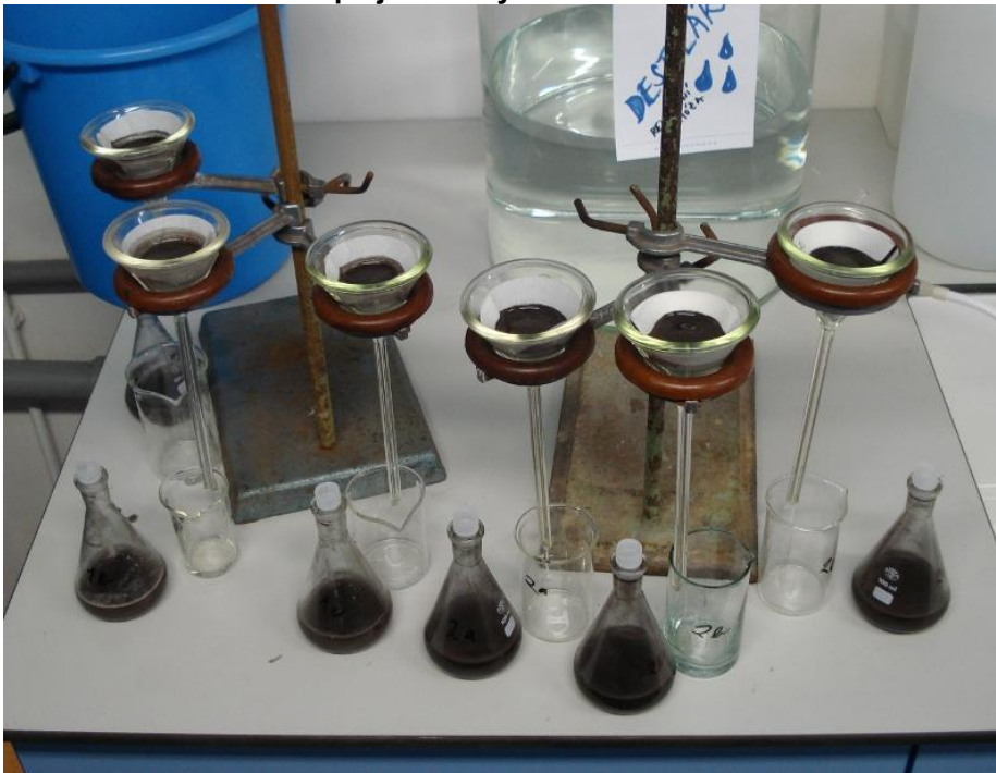
Obr. 22: Filtrace vzorků po jednotlivých krocích loužení
