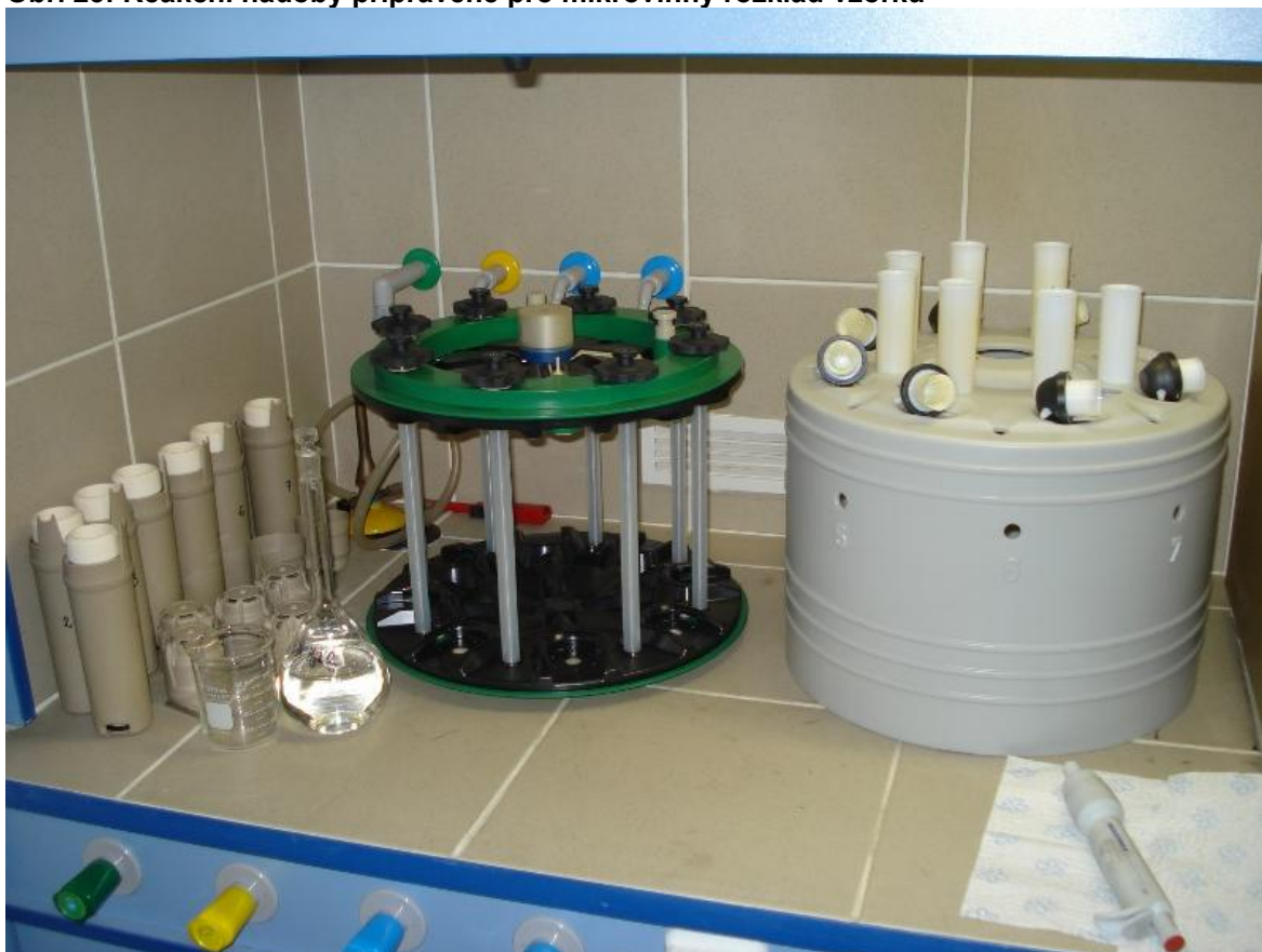
Obr. 23: Reakční nádoby připravené pro mikrovlnný rozklad vzorků
