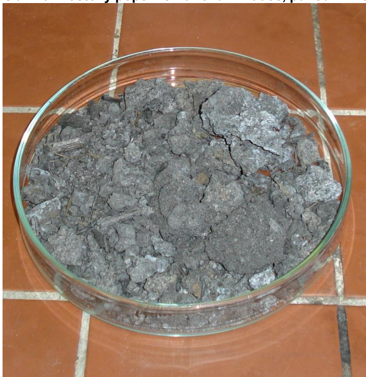
Obr. 10: Roštový popel - Jindřichův Hradec, původní vzorek
