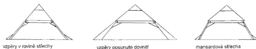
Obr. 8: Sklon vzpěr ležatých stolic (Vinař, 2010)
