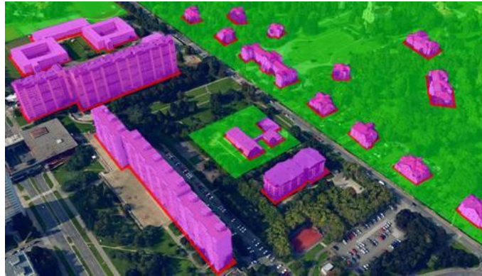
Obrázek 9 – Příklad chráněného vnitřního prostoru staveb (značen fialově) (13)
