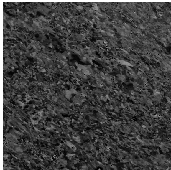
Obr. 66: Typický snímek mikrostruktury UFG mědi z mikroskopu Tescan TS 5130 MM.
