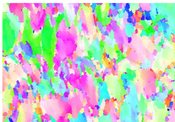
Obr. 50: Mapa IPF pro směr RD oblasti 3 po filtraci dle verze 1. Domácí zařízení, 15 kV.
