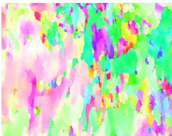
Obr. 49: Mapa IPF pro směr RD oblasti 2 po filtraci dle verze 1. Domácí zařízení, 15 kV.
