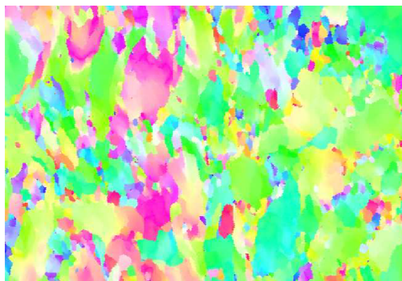
Obr. 48: Mapa IPF pro směr RD oblasti 3 po korekci na drift. Etalonové zařízení, 25 kV.
