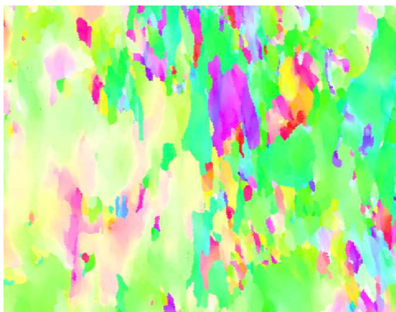
Obr. 47: Mapa IPF pro směr RD oblasti 2 po korekci na drift. Etalonové zařízení, 15 kV.
