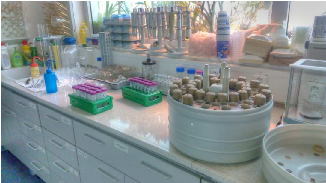
Obr. č. 9 Rotor přístroje Multiwave PRO, plnění reakčními nádobkami.
