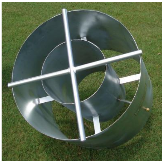
Obr. č. 9: Vsakovací dvouprstavec neboli double ring [O9]
