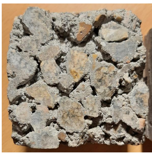
Obr. č. 34: Struktura vzorků po zkoušce obrusnosti
