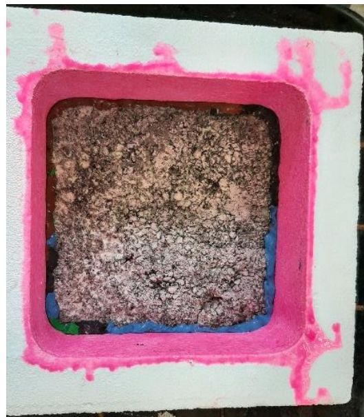
Obr. č. 26: Zkoušení vodopropustnosti (vlevo pomocí PVC, vpravo zkoušení na celou plochu vzorku)
