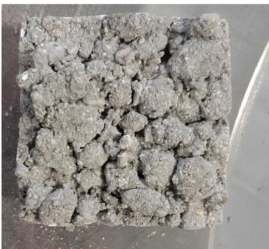
Obr. č. 33: Struktura vzorků před zkouškou obrusnosti
