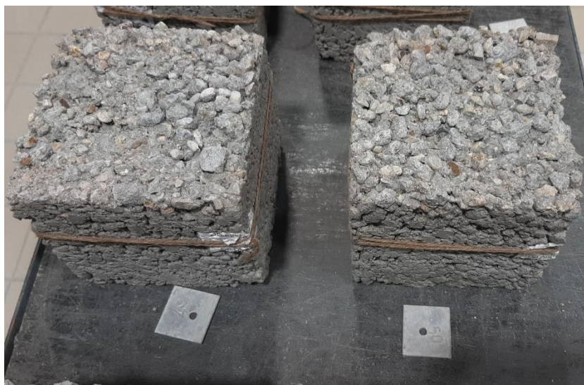
Obr. č. 31: Receptura H3 po zkoušce odolnosti proti CHRL
