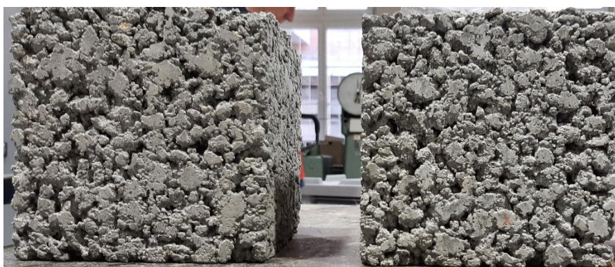
Obr. č. 28: Struktura receptury H1, vzorky před zkouškou pevnosti v tlaku
