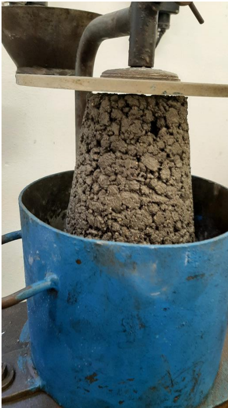
Obr. č. 25: Konzistence betonové směsi dle Vebe
