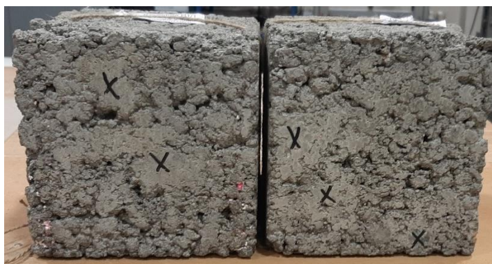
Obr. č. 29: Struktura receptury H1/1, vzorky před zkouškou pevnosti v tlaku
