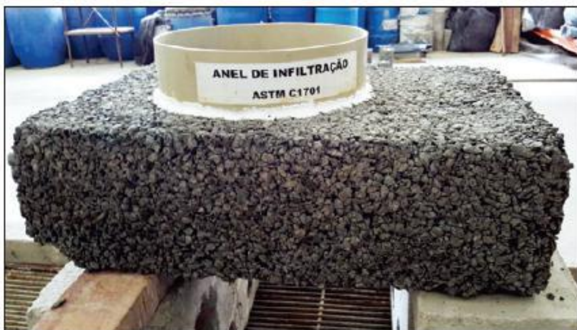
Obr. č. 7: Ilustrativní obrázek ke zkoušení dle normy ASTM C1701/C1701M-21 [N4] [O7]
