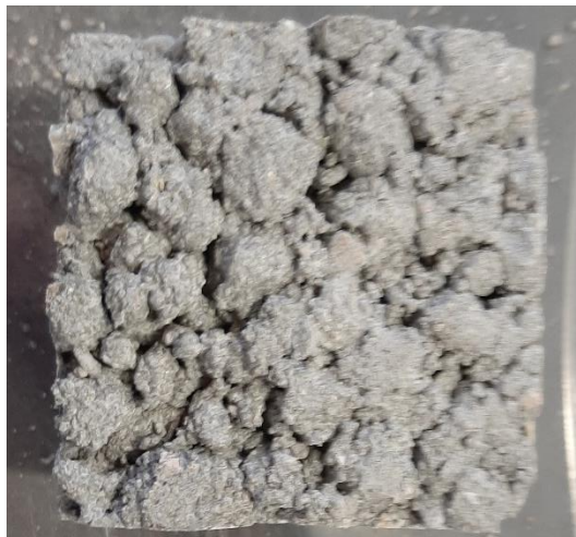
Obr. č. 33: Struktura vzorků před zkouškou obrusnosti
