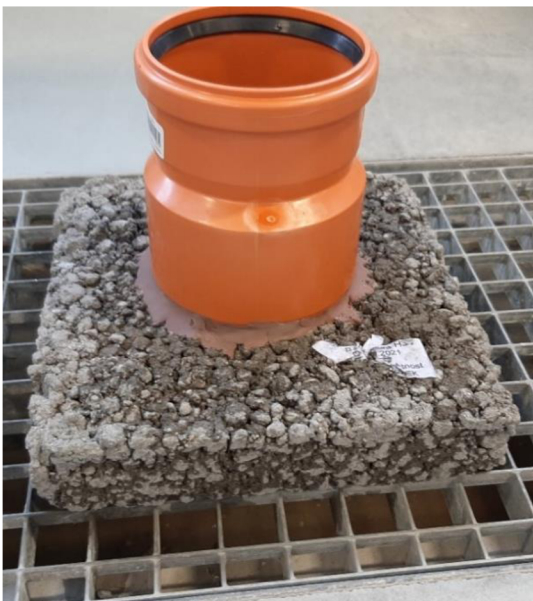
Obr. č. 26: Zkoušení vodopropustnosti (vlevo pomocí PVC, vpravo zkoušení na celou plochu vzorku)
