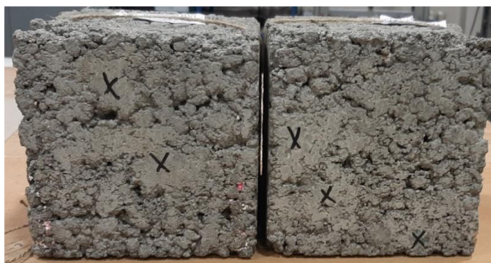
Obr. č. 29: Struktura receptury H1/1, vzorky před zkouškou pevnosti v tlaku
