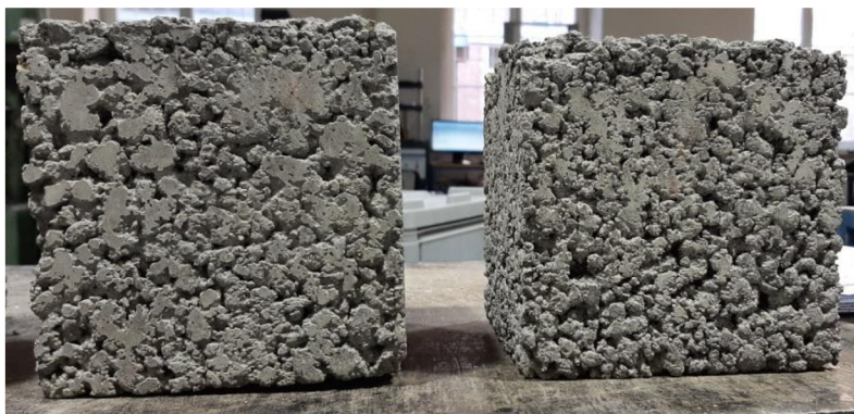
Obr. č. 27: Struktura receptury H3, vzorky před zkouškou pevnosti v tlaku
