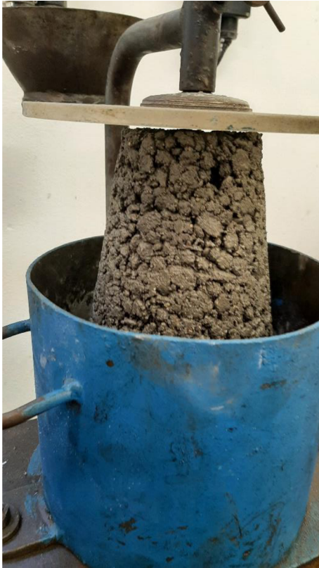
Obr. č. 25: Konzistence betonové směsi dle Vebe
