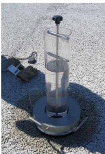
Obr. č. 10: Zkušební zařízení dle normy ČSN EN 12697-40 [O10]
