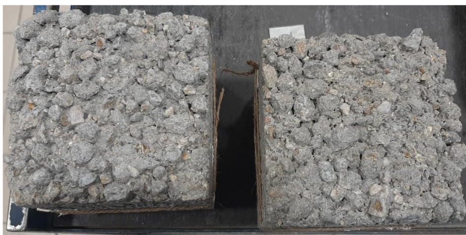
Obr. č. 32: Receptura H1/1 po zkoušce odolnosti proti CHRL
