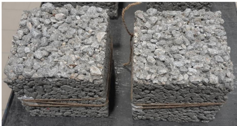
Obr. č. 30: Receptura H1 po zkoušce odolnosti proti CHRL
