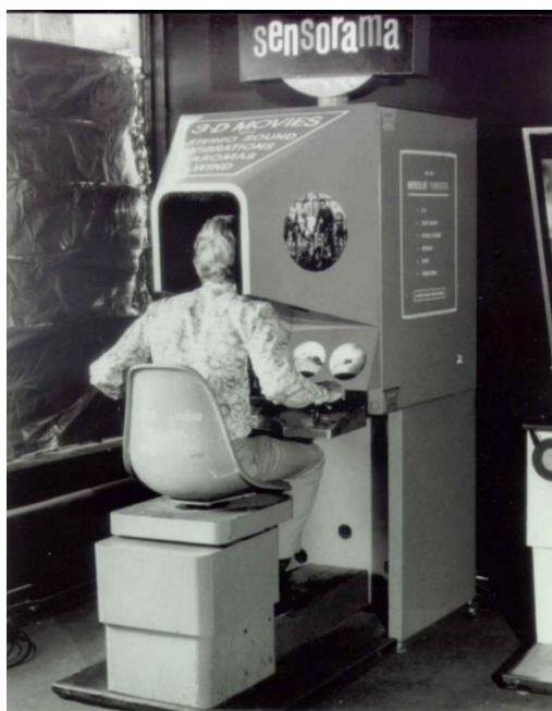
Obr. 9. Sensorama – jeden z prvních pokusů o vytvoření zařízení pro virtuální realitu (Zdroj: online https://blog.usejournal.com/what-is-augmented-reality-69b38c1a1c4f )
