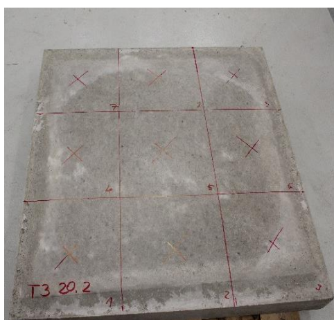
Obr. G-13-2 Drátkobetonová deska D3, vyznačené body měření, testování koncentrace elektromagnetickou cívkou
