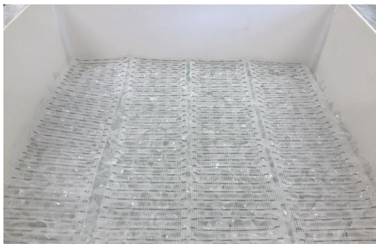
Obr. F-11-2 Výroba zkušebního tělesa z epoxidové pryskyřice tzv. směrového vzorku, uložení ocelových vláken v jednom směru v daných vzdálenostech
