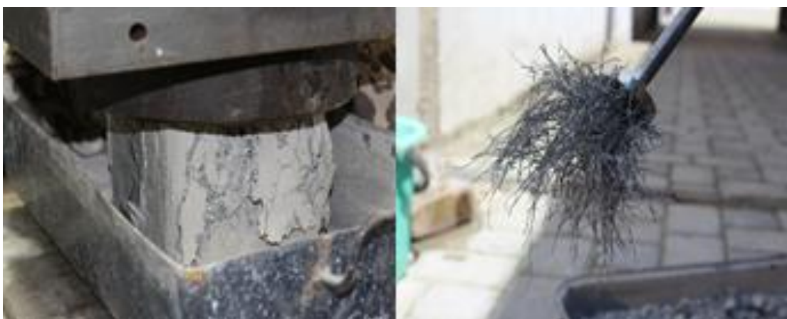
Obr. G-12-1 Destruktivní zkouška referenčních těles - drátkobetonové krychle; separace drátků (vpravo)
