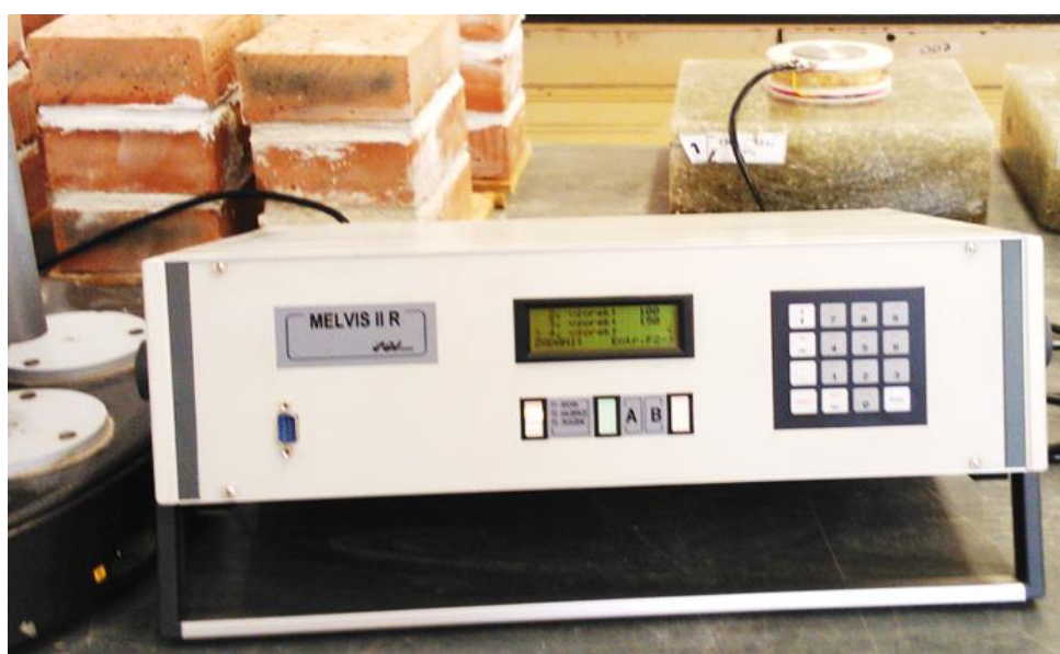
Obr. B-4-8 Přístroj Melvis – testování pryskyřicového zkušebního tělesa
