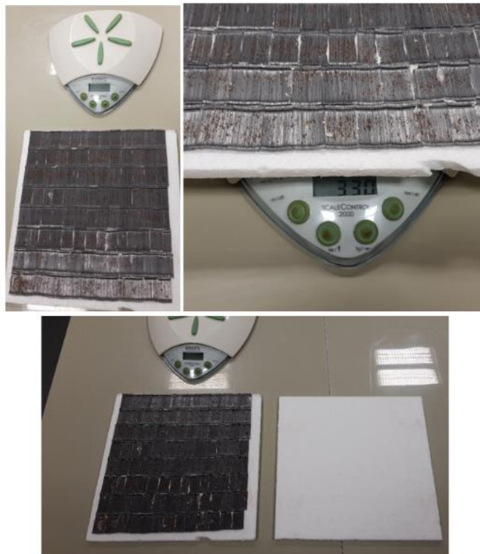
Obr. F-9-3 Měření hmotnosti testovacích materiálů fantomového kompozitního vzorku –polystyrenové desky a drátková plná vrstva
