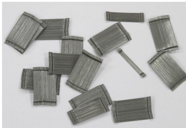
Obr. F-11-11 Příklad testovaných ocelových drátků (elementů) kompozitního materiálu
