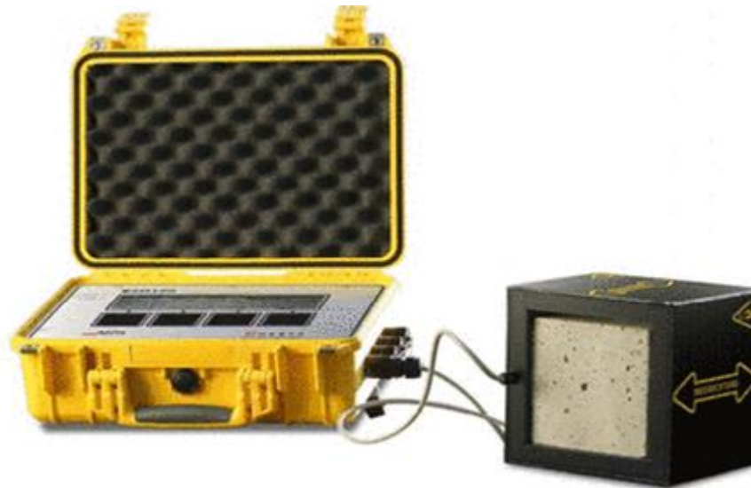
Obr. B-4-5 Přístroj BSM 100 pro stanovení obsahu ocelových vláken v drátkobetonu [62]
