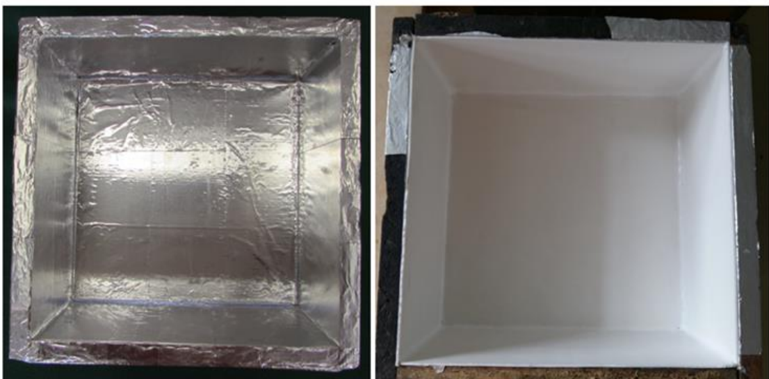
Obr. F-11-1 Formy pro výrobu zkušebních těles z epoxidové pryskyřice; vlevo – použití alobalové pásky, vpravo – použití silikonové pryže
