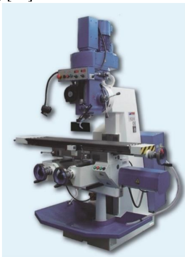
Obr. 14 Konzolová frézka F2V-R [17].
