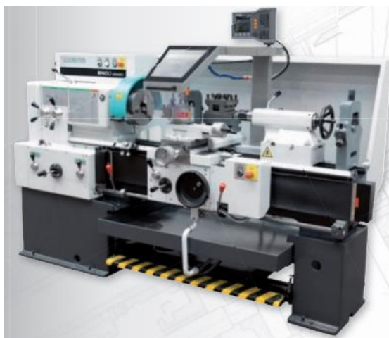
Obr. 13 Univerzální hrotový soustruh SN 32 [7].
