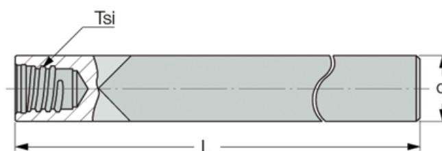
Obr. 34 Upínací válcová stopka MM GRT-095-T06 [18].
