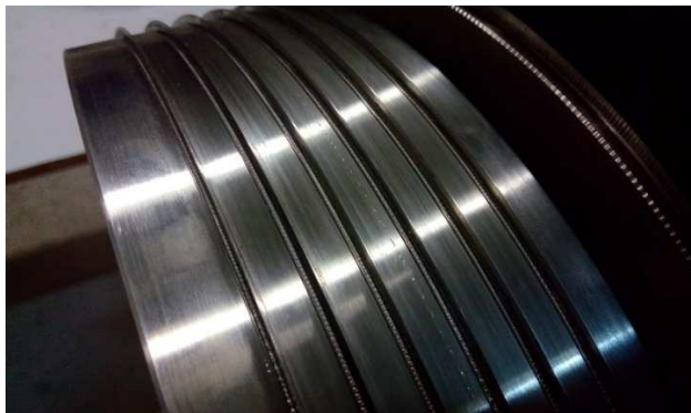
Obr. 94 Detail jednostranného labyrintu
