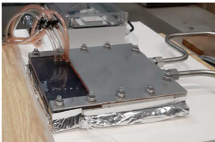
Obr. 130 Statický stand s vyměnitelnou geometrií labyrintu
