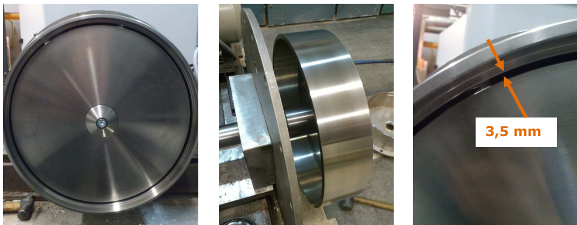
Obr. 53 Hladký rotor – sestavení, radiální vůle
