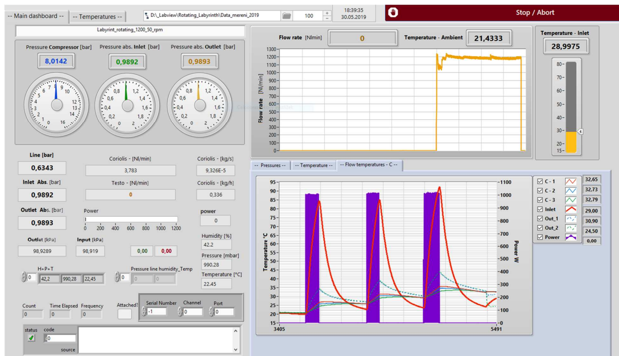
Obr. 48 Softwarové rozhraní pro sledování a záznam dat z jednotlivých snímačů
