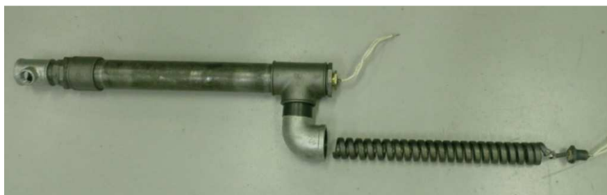
Obr. 47 Soustava topných těles tvořící I. a II. stupeň ohřevu vstupního vzduchu
