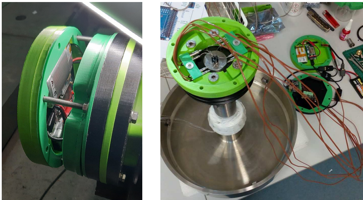
Obr. 51 Telemetrický systém při vyjímání baterií pro nabíjení - (vlevo) a rozložené komponenty před kalibrací termočlánků včetně převodníků (modulů) a záznam dat.
