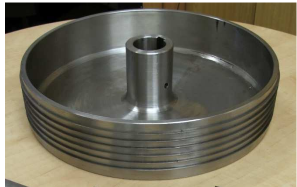
Obr. 95 Pohled na vnitřní část rotoru s jednostranným labyrintem
