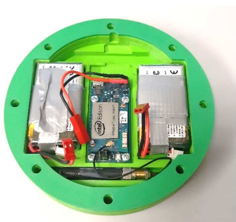
Obr. 50 Mikropočítač Intel Edison, 2x baterie, Wi-Fi anténa
