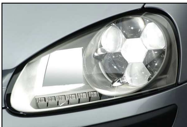
Obr. č. 4 – 17 Prototyp LED svetlometu [11]
