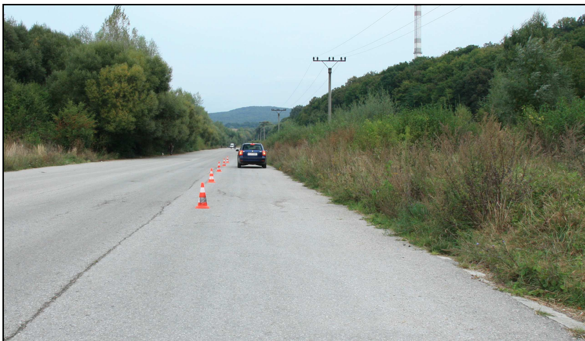
Obr. č. 4 – 33 Vozidlo Škoda Octavia II so zapnutými obrysovými, brzdoými a smerovými svetlami vo vzdialenosti 40 m od VBM
