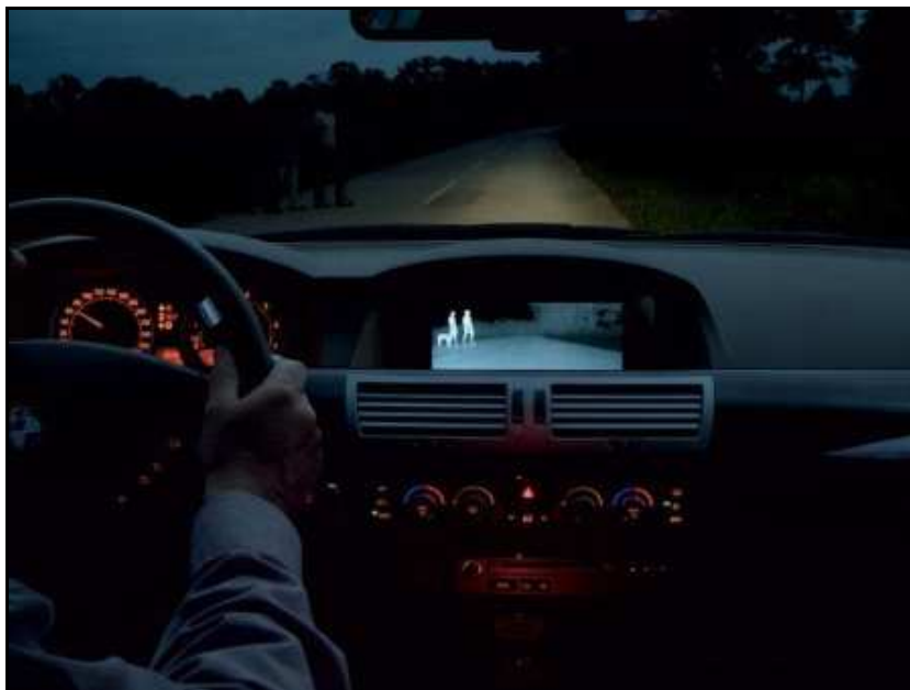
Obr. č. 4 – 23 Systém nočného videnia vo vozidle BMW [5]
