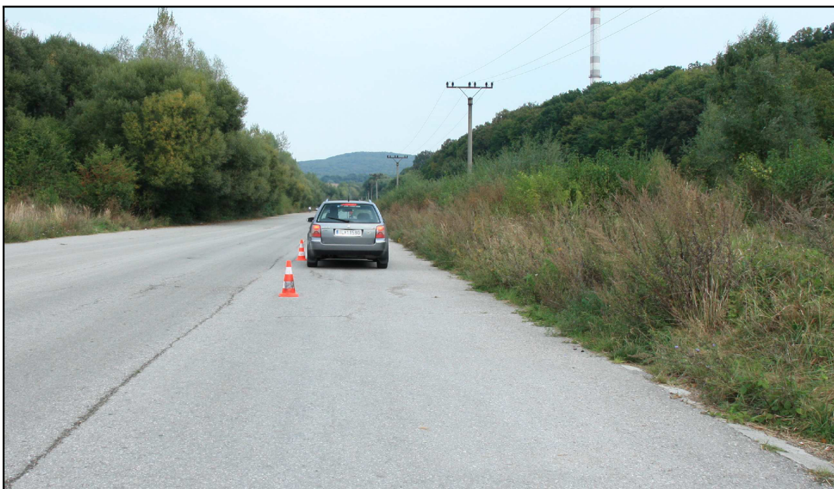
Obr. č. 4 – 32 Vozidlo Volkswagen Passat so zapnutými obrysovými a brzdoými svetlami vo vzdialenosti 20 m od VBM
