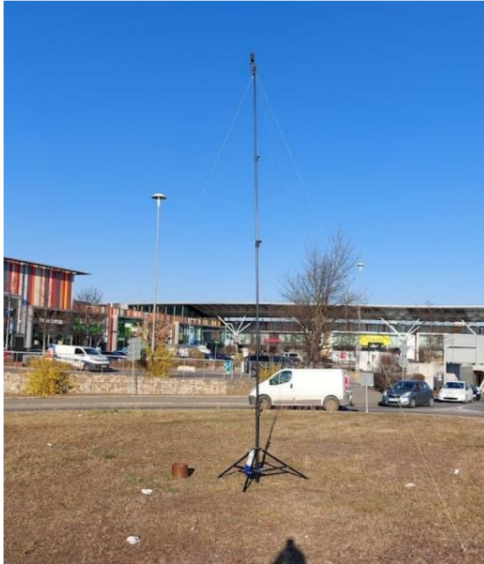
Obr. 6.8: Teleskopický stožár maximální výšky 7 m osazený kamerou s 360° záběrem a vysokým rozlišením (JOK Brno-Bohunice).
