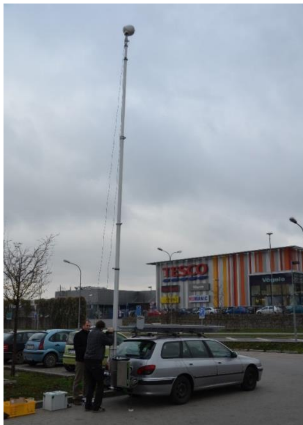
Obr. 6.7: Teleskopický stožár maximální výšky 17 m osazený dálkově ovládanou kamerou s vysokým rozlišením.
