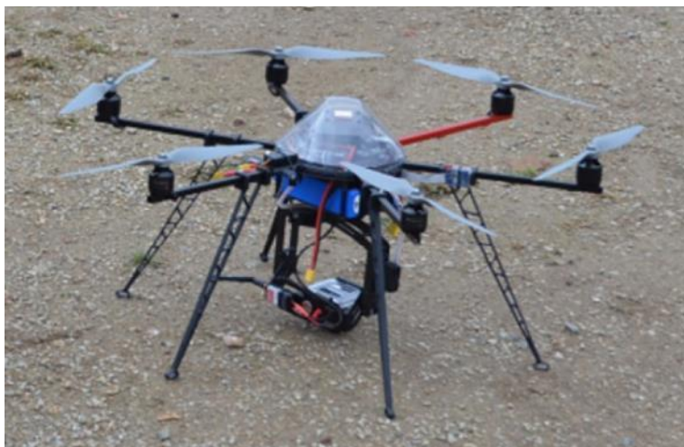
Obr. 6.2: Hexakoptéra s podvěšenou kamerou s vysokým rozlišením.
