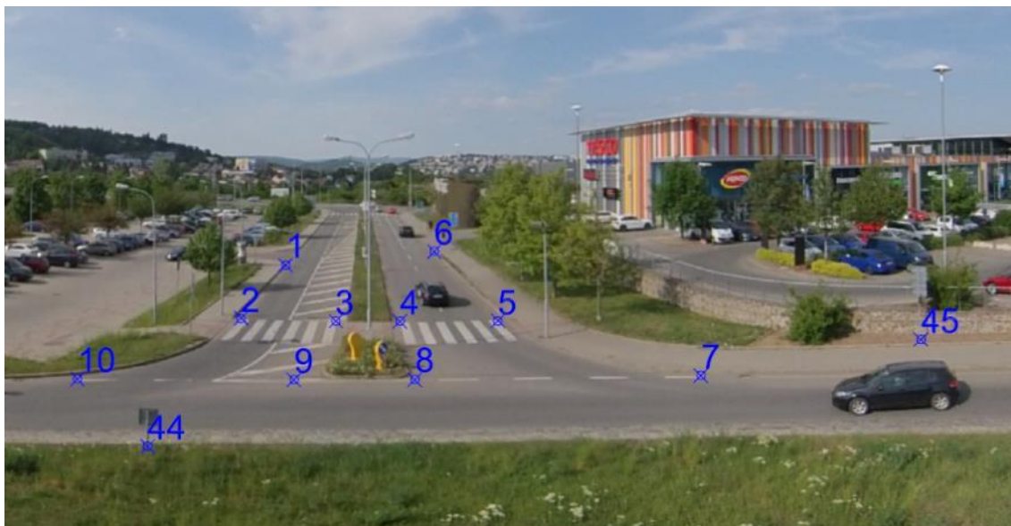
Obr. 6.22: Zanesení zaměřených bodů do snímku z pořízeného videozáznamu.
