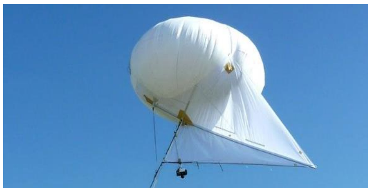
Obr. 6.3: Helikite s podvěšenou kamerou s vysokým rozlišením.
