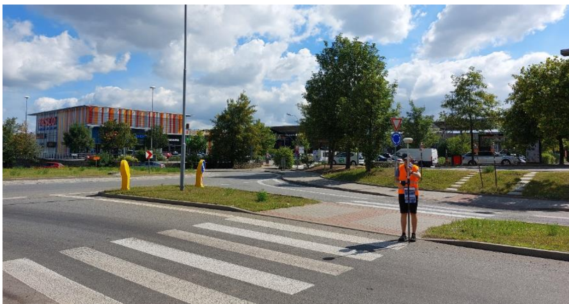
Obr. 6.21: Zaměření křižovatky pomocí GPS stanice, které umožňuje jednotlivým pixelům záběru přiřadit globální polohopisné souřadnice.
