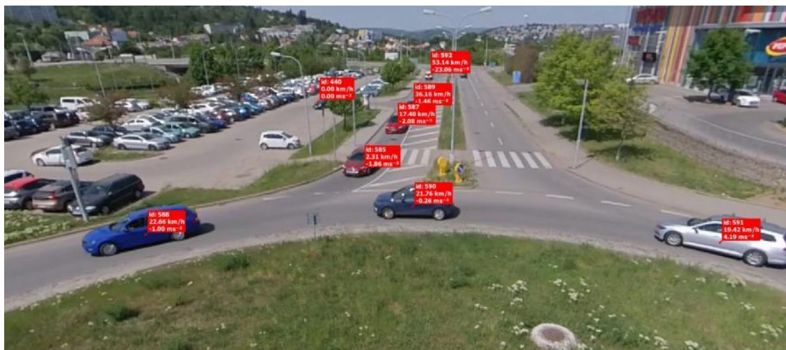
Obr. 6.25: Kontrola hodnot rychlosti a zrychlení vozidel po provedení georeference videozáznamu v softwaru Data From Sky.
