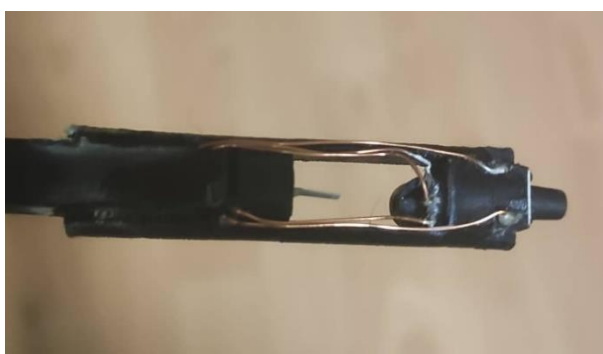
Obrázek 3.5: Koncový segment osazený senzory
