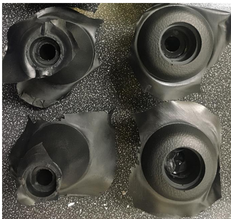
Obr. 8) Páčky volantů se zbytky vtokové soustavy
