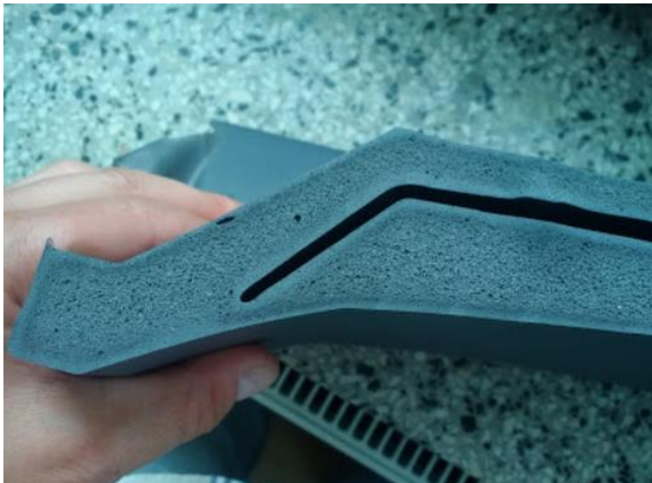
Obr. 4) Ukázka struktury integrální pěny [19]
