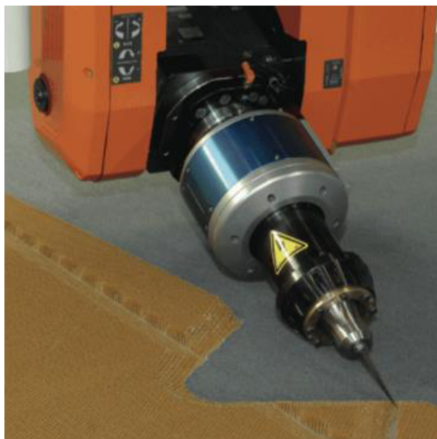
Obr. 22) Ultrazvuková obráběcí hlava na efektoru robotu [43]
