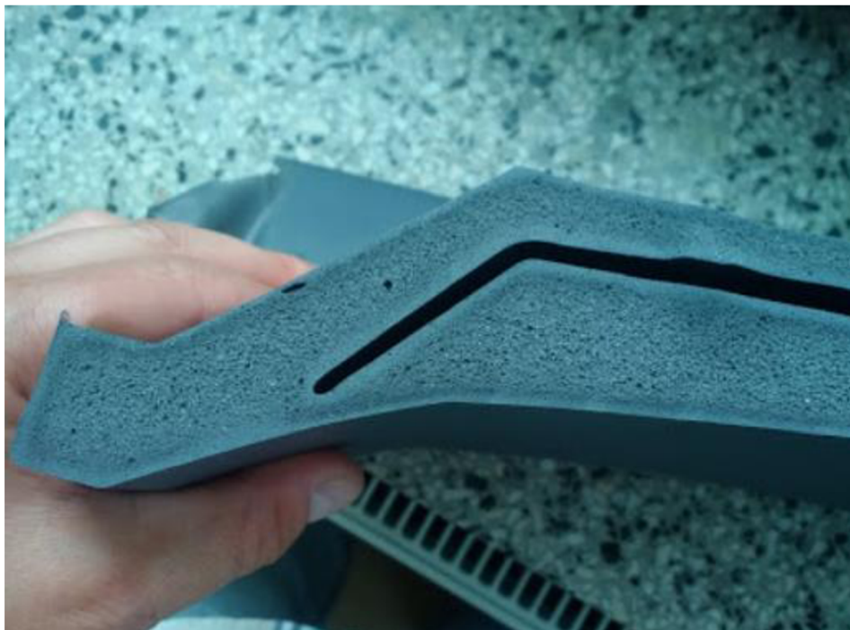
Obr. 4) Ukázka struktury integrální pěny [19]
