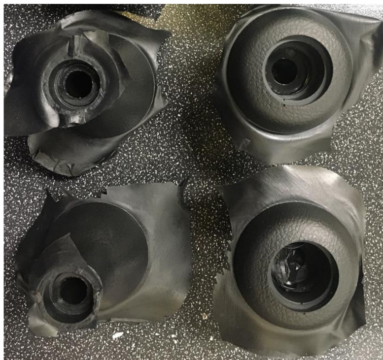
Obr. 8) Páčky volantů se zbytky vtokové soustavy
