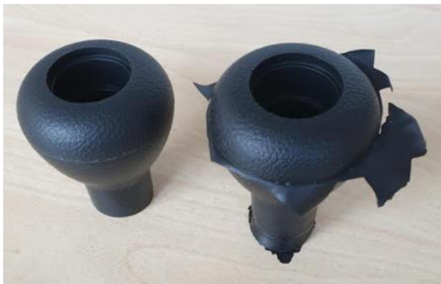
Obr. 13) Páčka před opracováním a po opracování
