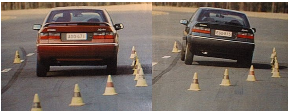
Obr. 22 Porovnanie dvoch vozidiel Citroën Xantia vybavených aktívnym (vľavo) a pasívnym (vpravo) stabilizátorom pri úhybnom manévri vo vysokej rýchlosti. [12]
