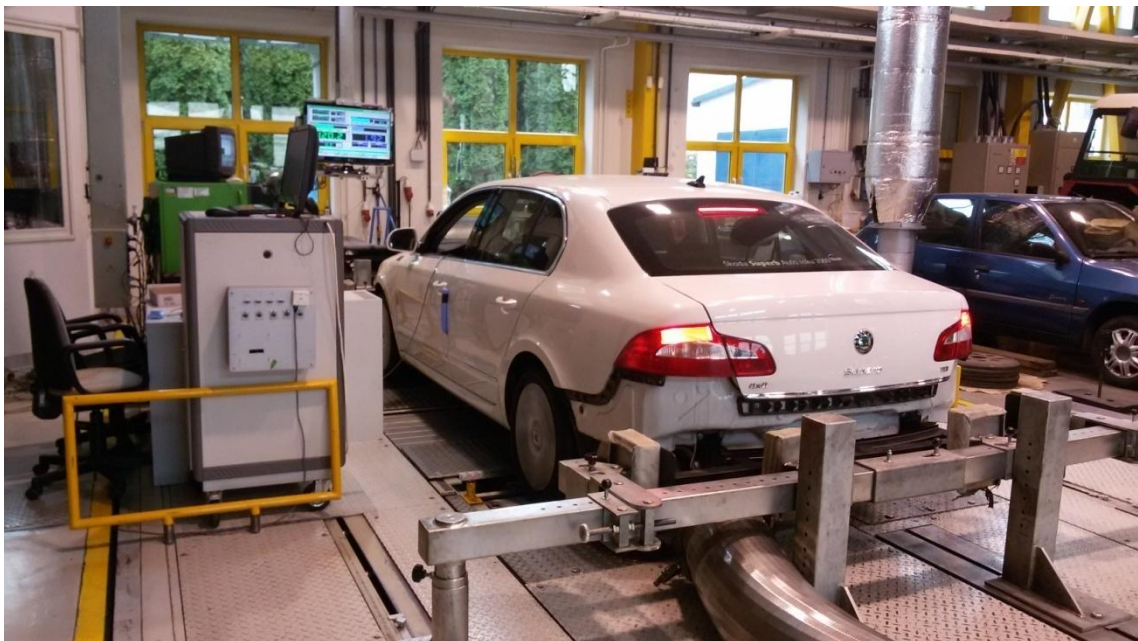
Obr. 28 Upevnění vozidla na válcové zkušebně, Zdroj: autor
