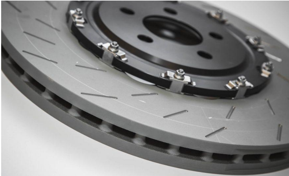
Obr. 12 Brzdový kotouč litina-hliník, Zdroj: CAR AND DRIVER, 2017
