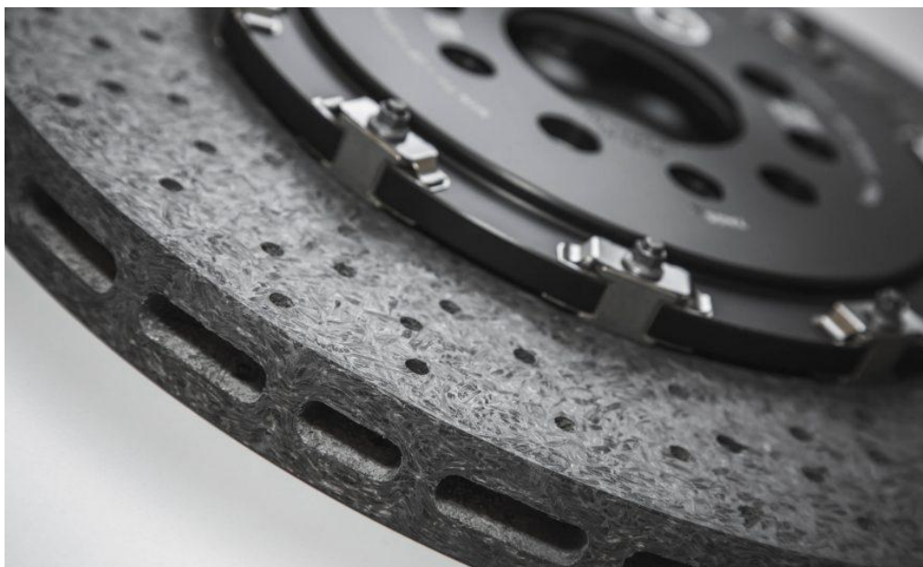
Obr. 10 Brzdový kotouč uhlík-keramika, Zdroj: CAR AND DRIVER, 2017
