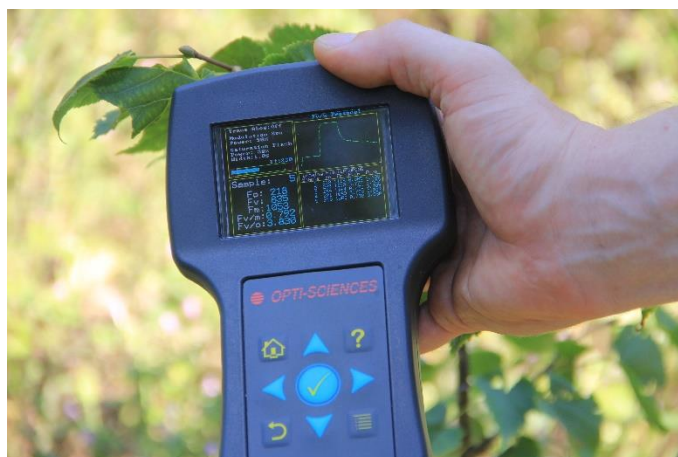
Obrázek 7 a 8: Měření obsahu a fluorescence chlorofylu pomocí přístrojů Opti-Science CCM-300 (vlevo), Opti-Sciences OS30p+ (vpravo). Foto: Růžena Vrkočová
