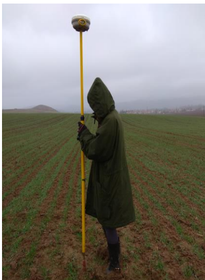
Obr. 3 – Meranie prijímačom GNSS-RTK R4
