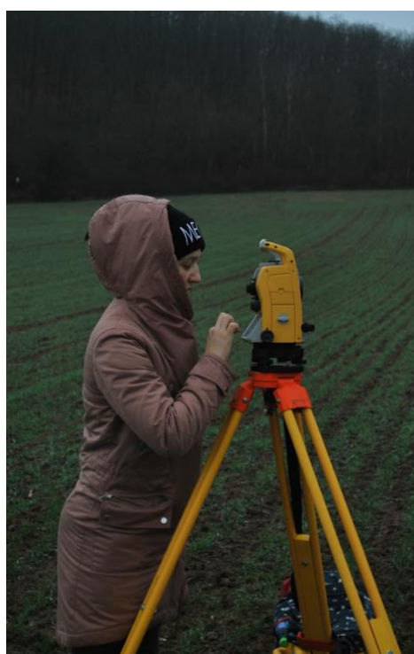
Obr. 4 – Meranie totálnou stanicou Trimble M3-DR2
