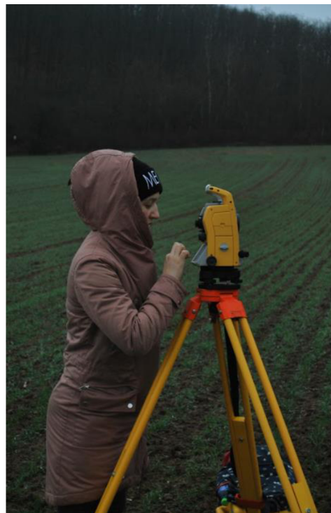
Obr. 4 – Meranie totálnou stanicou Trimble M3-DR2
