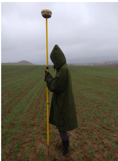
Obr. 3 – Meranie prijímačom GNSS-RTK R4
