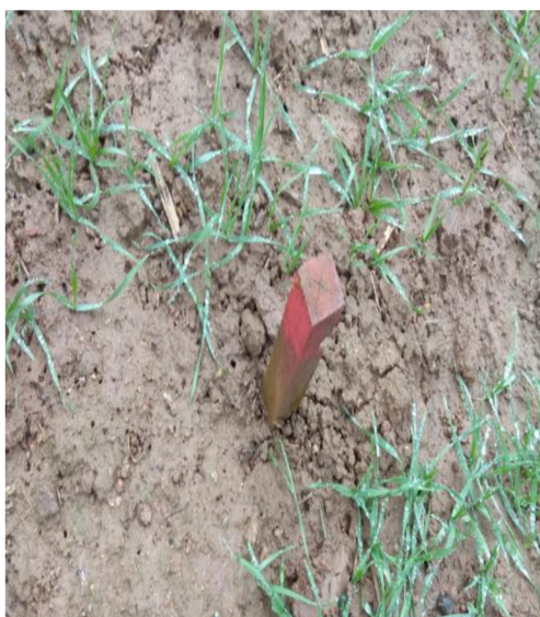
Obr. 5 – Stabilizácia bodov pomocnej meračskej siete dreveným kolíkom
