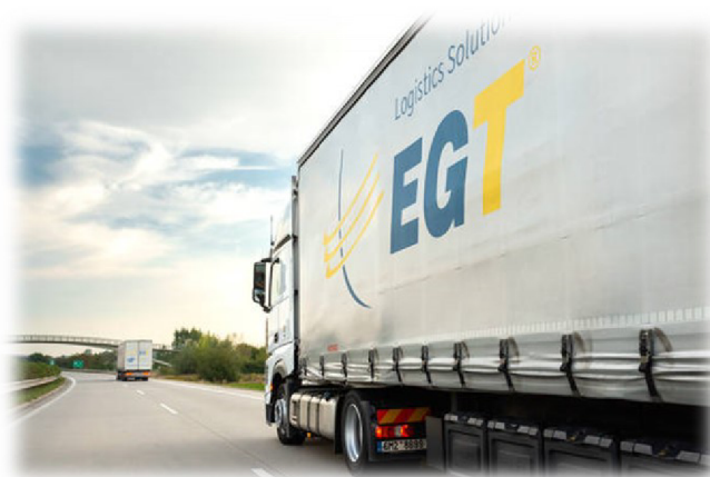
Obr. 2.4 - Lowdeck, čili nízkopodlažní souprava
