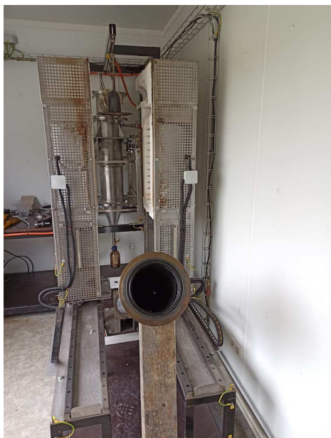
Obr. 2.8 Pyrolýzní stroj v centru AdMaS
