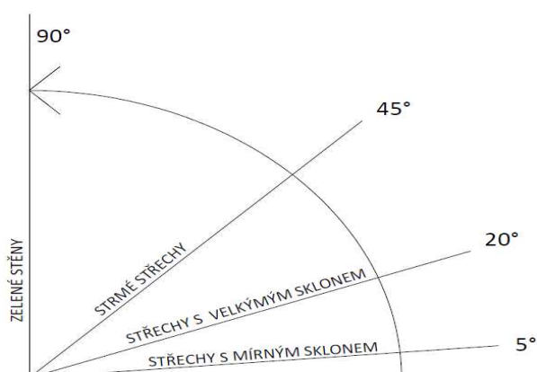
Obr. 3.3 Rozdělení zelených střechech dle sklonu
