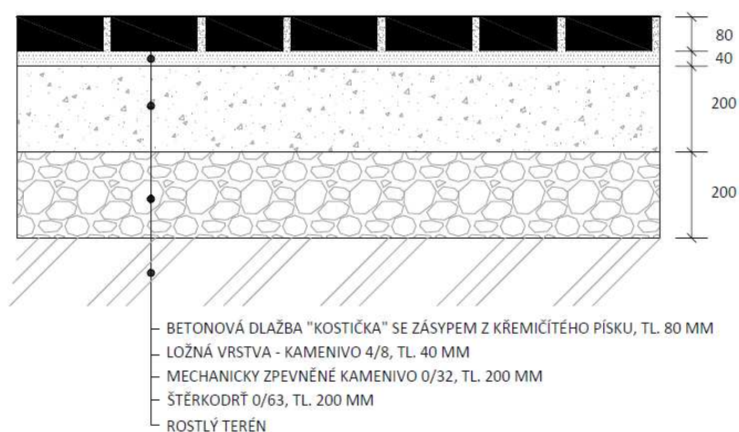
Obr. 4.7 Řez sklady parkoviště s betonovou dlažbou
