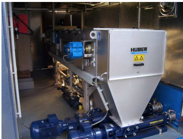
Obr. 2.1 Pásový zahušťovač kalu firmy HUBER [12]
