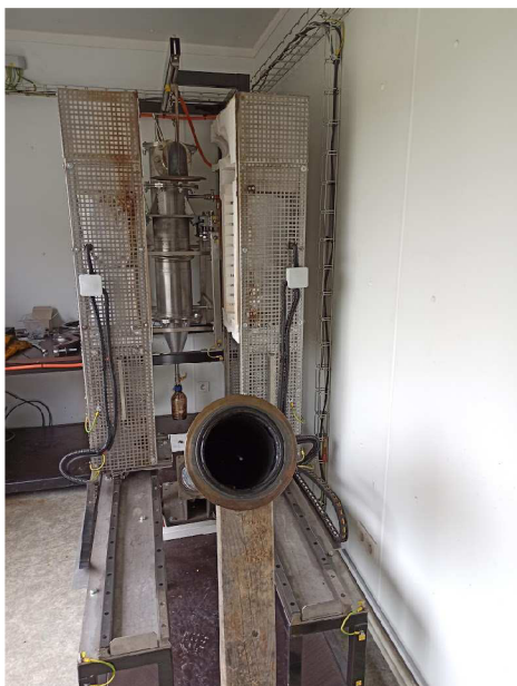
Obr. 2.8 Pyrolýzní stroj v centru AdMaS
