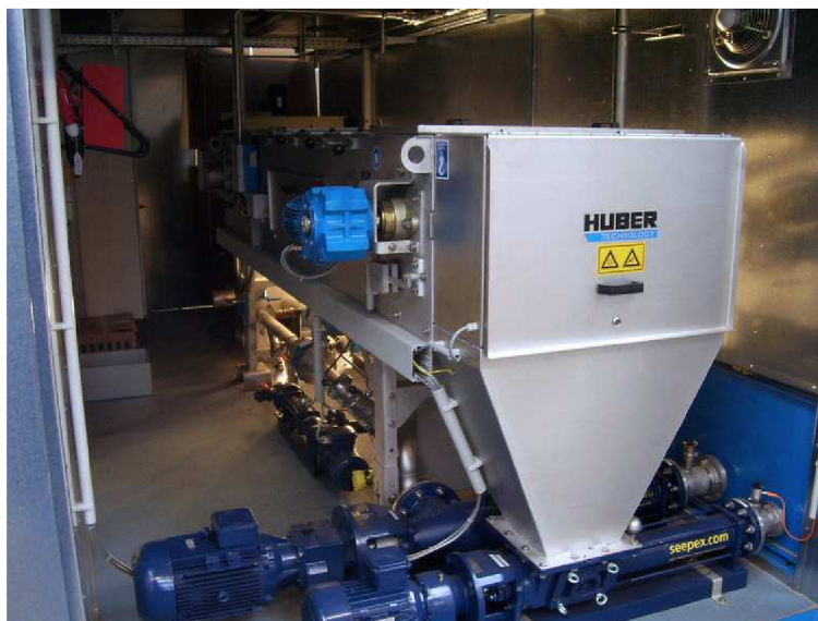
Obr. 2.1 Pásový zahušťovač kalu firmy HUBER [12]
