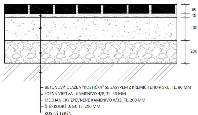
Obr. 4.7 Řez sklady parkoviště s betonovou dlažbou
