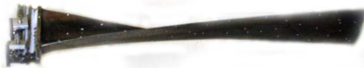
Obrázek 5.1: Dostupný exemplář lopatky parní turbíny
