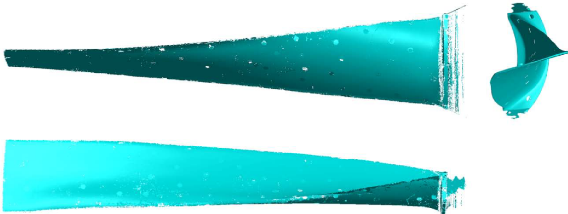
Obrázek 5.6: Naskenovaná data v prostředí Pro/ENGINEER
