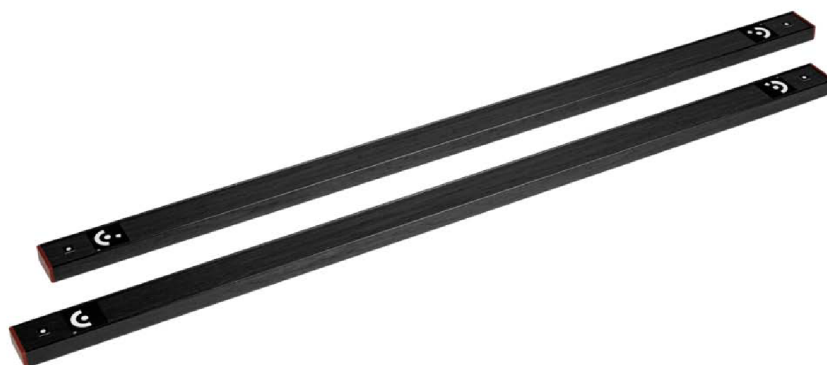
Obrázek 5.4: Speciální značky na kalibračních tyčích pro systém TRITOP[10]
