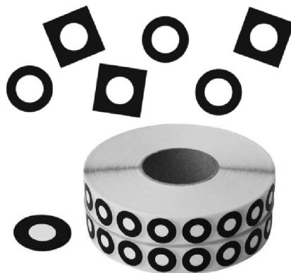
Obrázek 5.2: Speciální značky pro systém ATOS[9]
