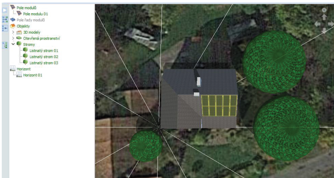
Obrázek 8.4 PV*SOL - umístění domu včetně okolních stromů
