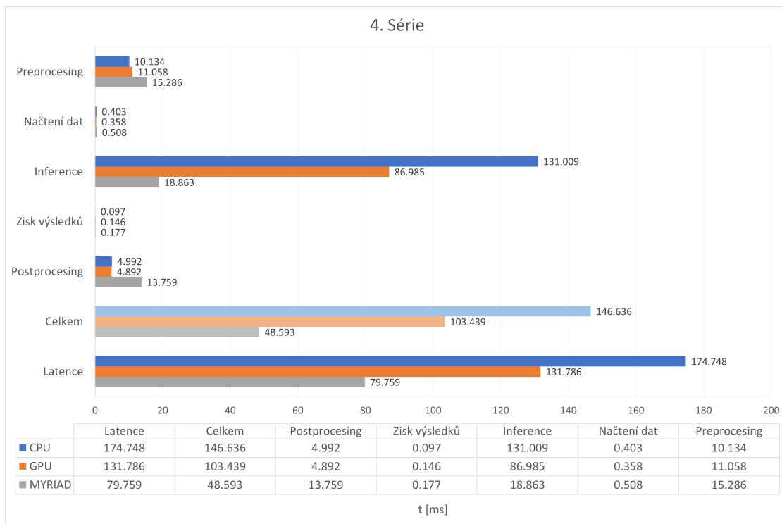
Obrázek 6.10: Graf 4. Série. Graf znázorňuje dosažené výsledky rozpoznávání s použitím modelu FaceNet . Experiment byl proveden s videem, zobrazující dvě osoby.
