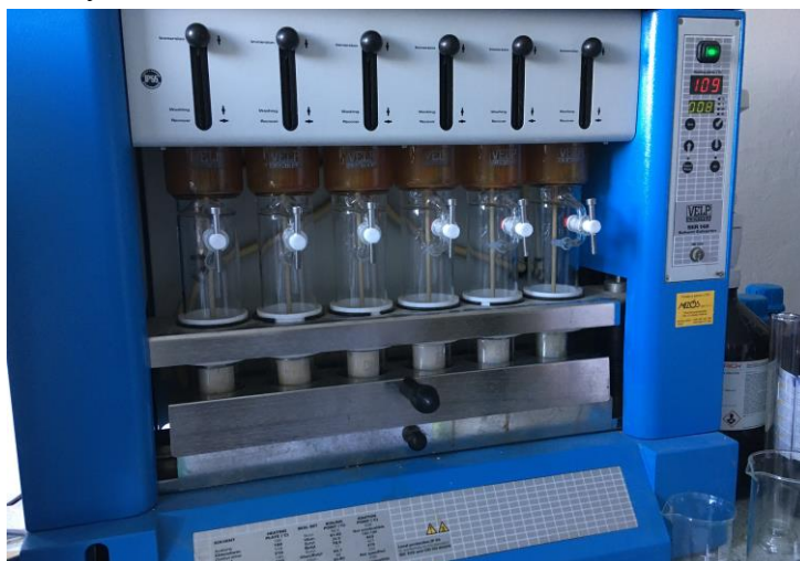
Obrázek 3: Přístroj Velp SER 148/6 Solvent Extraction Unit se 6 polohami.
