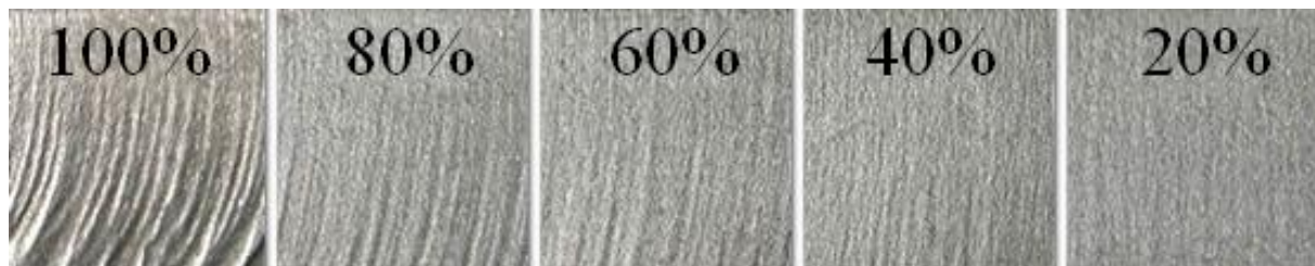
Obr. 3 Povrch řezané plochy v závislosti na procentuální rychlosti posuvu [18]
