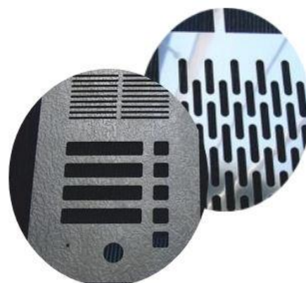
Obr. 5 Neporušená povrchová úprava po řezání laserem [9]
