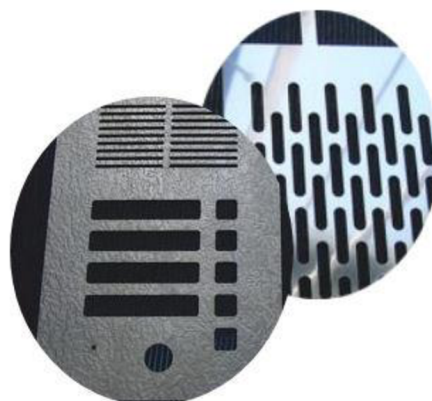
Obr. 5 Neporušená povrchová úprava po řezání laserem [9]
